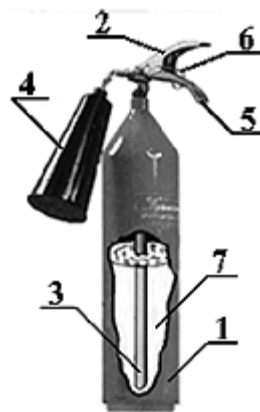
Рис 1.2. Устройство переносных углекислотных огнетушителей
