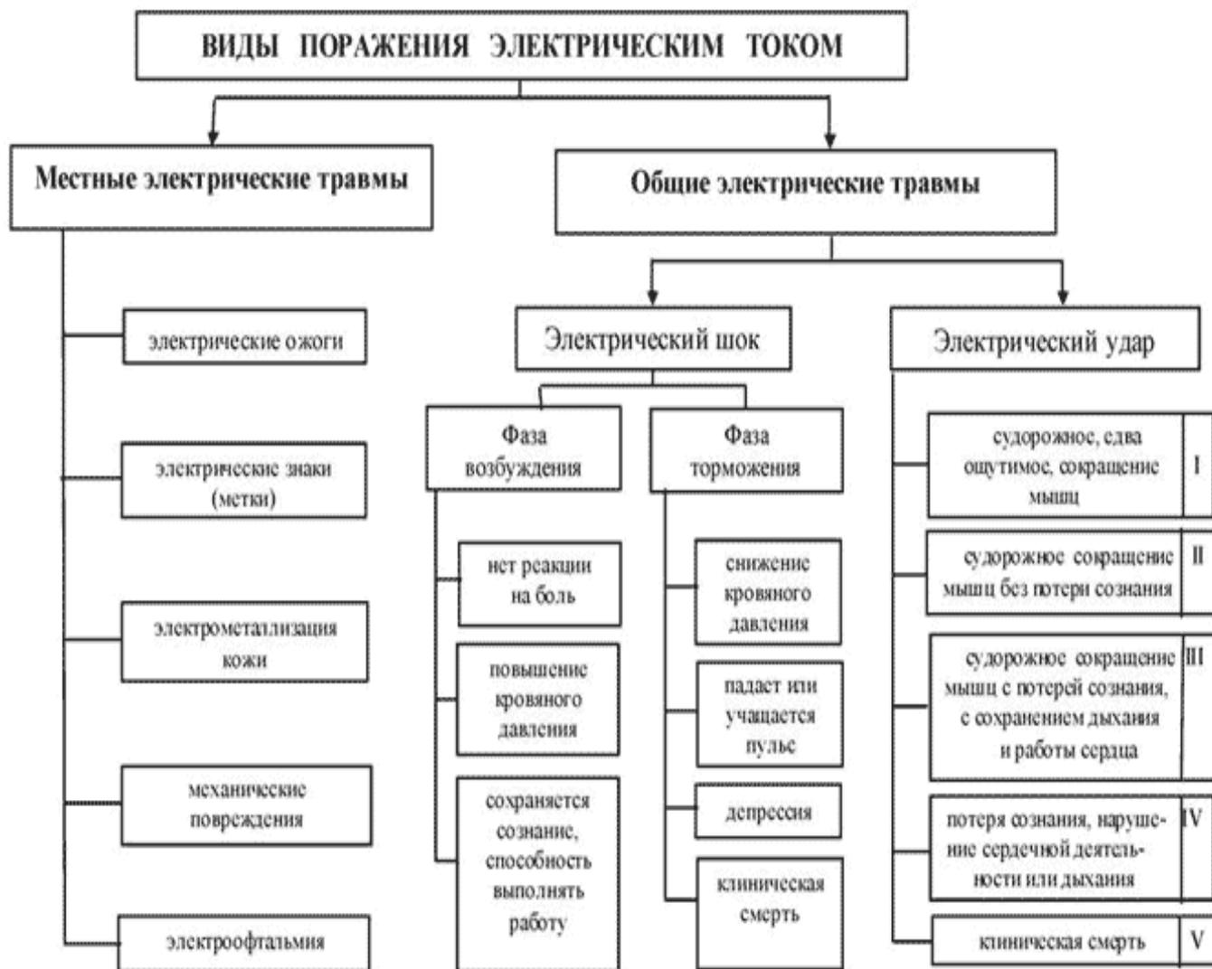
Рис. 2. Классификация видов поражения электрическим током
