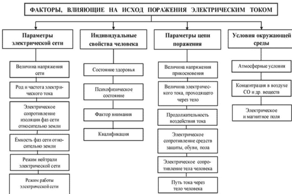
Рис. 1 Факторы, влияющие на поражение электрическим током.
